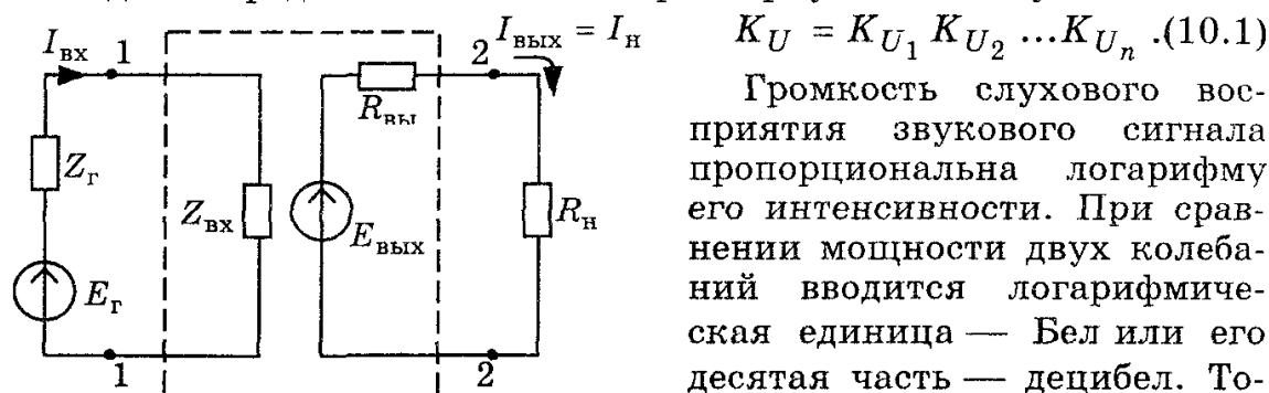
Рис.10.4. Представление усилителя в виде активного четырехполюсника
